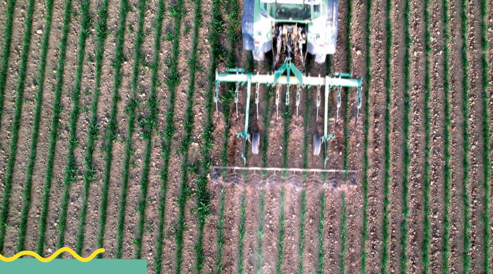
Pflege im Frühjahr mit Hacke und Kettenschlepp, auf einer Arbeitsbreite von 4,2m.
